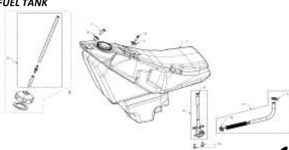
DEPÓSITO FUEL TANK
