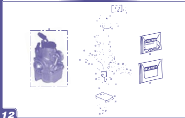
Carburador / Carburetor CASCAS TXT-PRO 03 125 / 200 / 250
